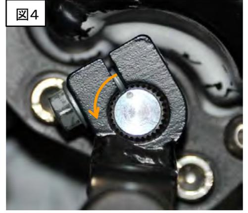
1) 純正のステップを取り外し、チェンジアームの角度を反時計回り方向にひと山ずらして下さい。
